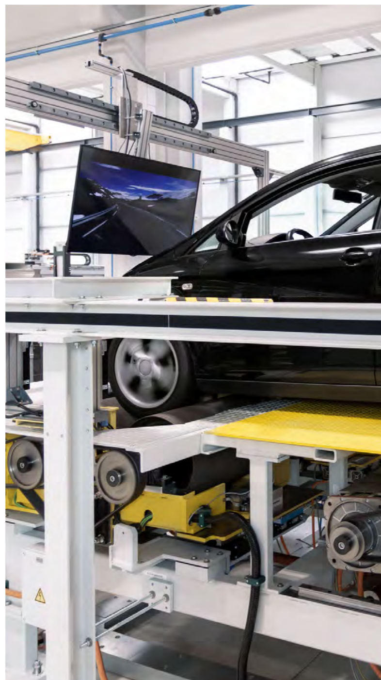
转向转鼓试验台x-road curve型在屏幕上模拟真实的驾驶状况
