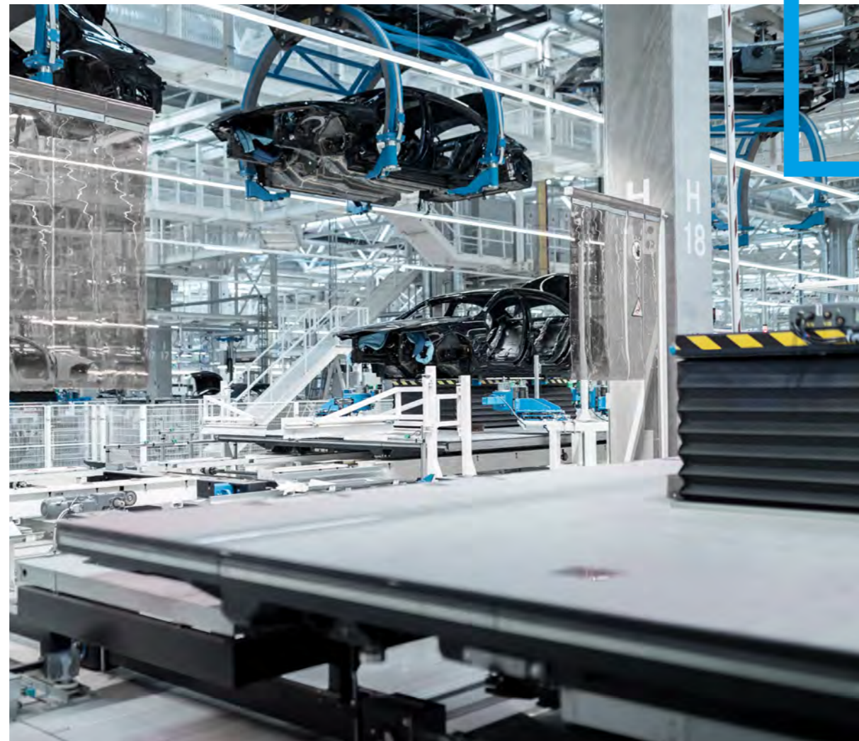
在生产环境中右下角带有集成升降台的大板输送机和顶部中间带有集成剪式升降机的EMS
