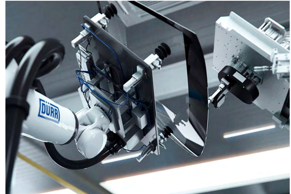
EcoShot Meter电动定量系统与EcoGun应用胶枪结合使用时，可确保胶条从开始到结束的互锁连接
